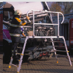
8 Het platform is klaar voor gebruik. (ca. 3 pers. + gereedschap).
