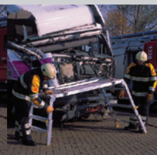
4 Het platform wordt eerst aan 1 zijde op hoogte geplaatst.
